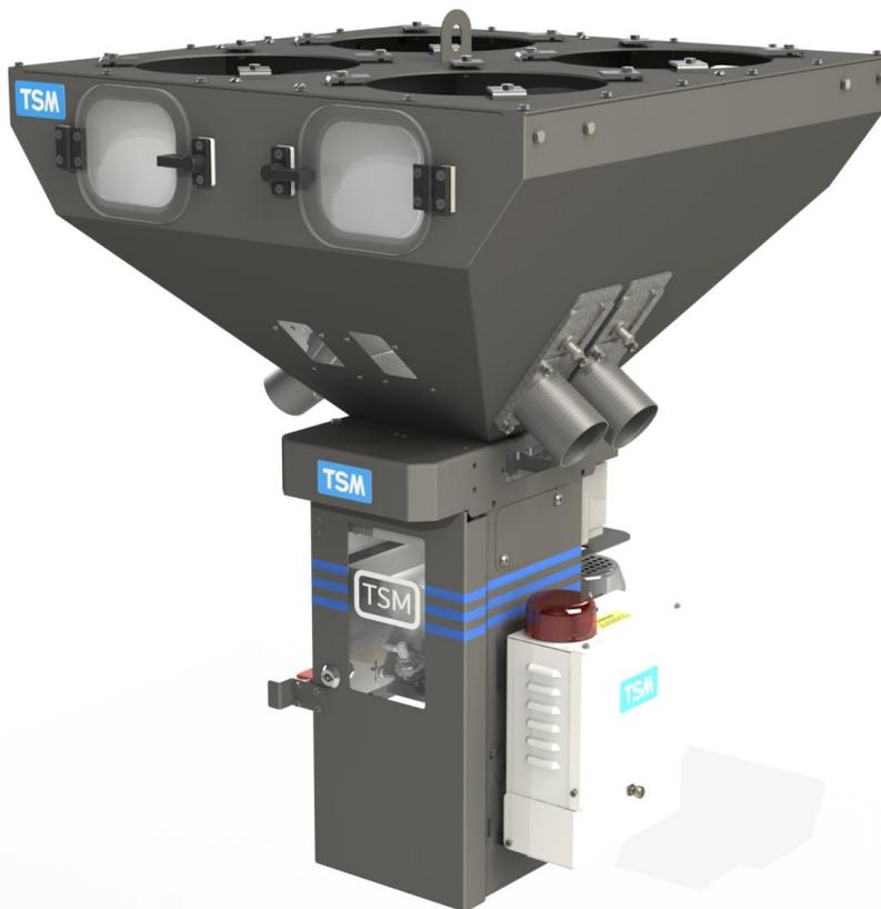
OPTI-MIX 200 在標準 4 種原物料供應下, 混料量範圍最高為 200 kg/hr, TSM 既實際又有效率的計量閥門設計及專利設計雙反向混料螺桿攪拌技術, 如此伴隨著高精度在同業產中的佼佼者. 微電腦控制所有原物料以設定的比例重量計量, 單一物料分別計量至一個稱重槽.
