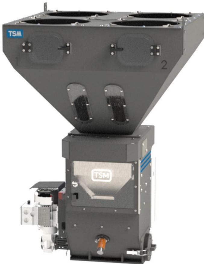
OPTI-MIX 300 在標準 4 種原物料供應下，混料量範圍最高為 300 kg/hr, TSM 既實際又有效率的計量閥門設計及專利設計雙反向混料螺桿攪拌技術，如此伴隨著高精度在同業產中的佼佼者。微電腦控制所有原物料以設定的比例重量計量，單一物料分別計量至一個稱重槽。
