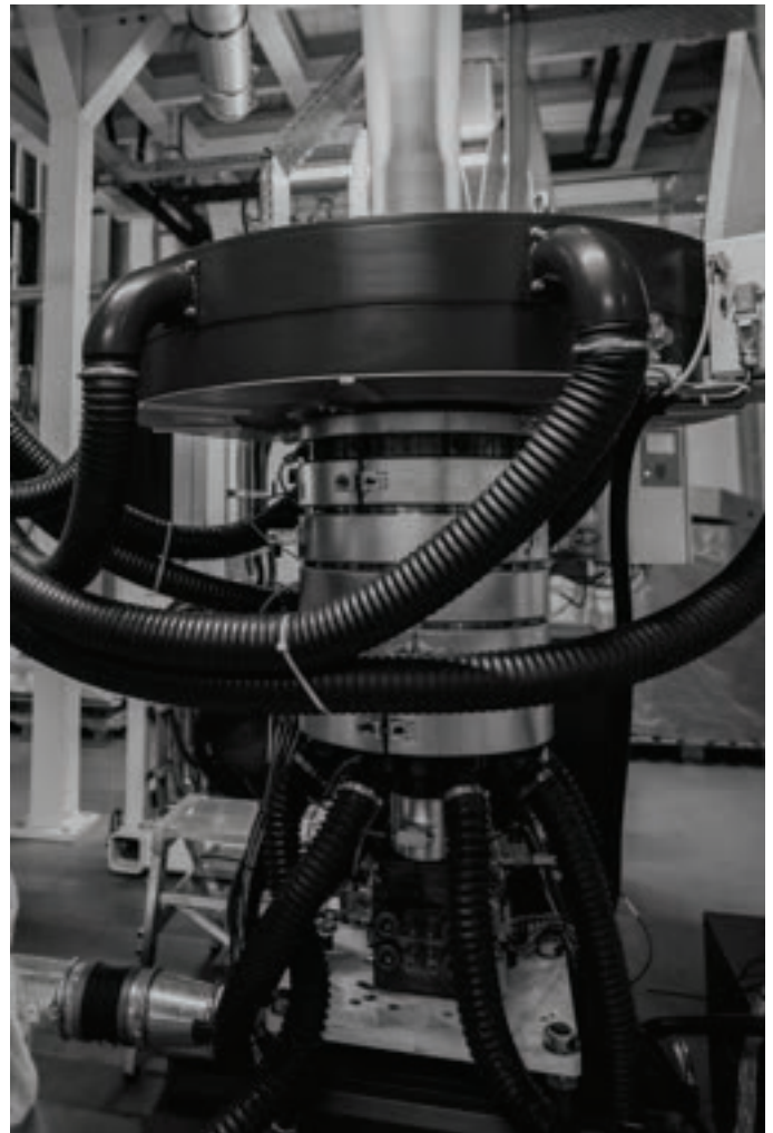
針對HDPE塑料自動風環給予最佳薄膜厚薄均勻度
