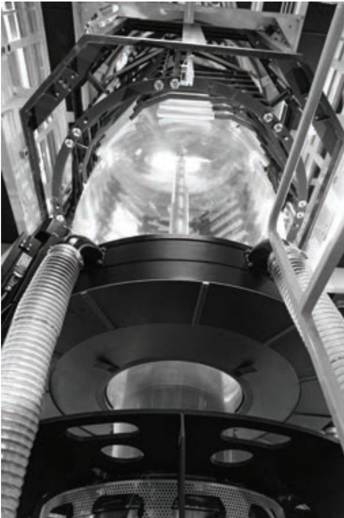
針對拉伸膜可調高度的自動風環，模頭尺寸 300mm，產能350 ~ 400公斤/小時
